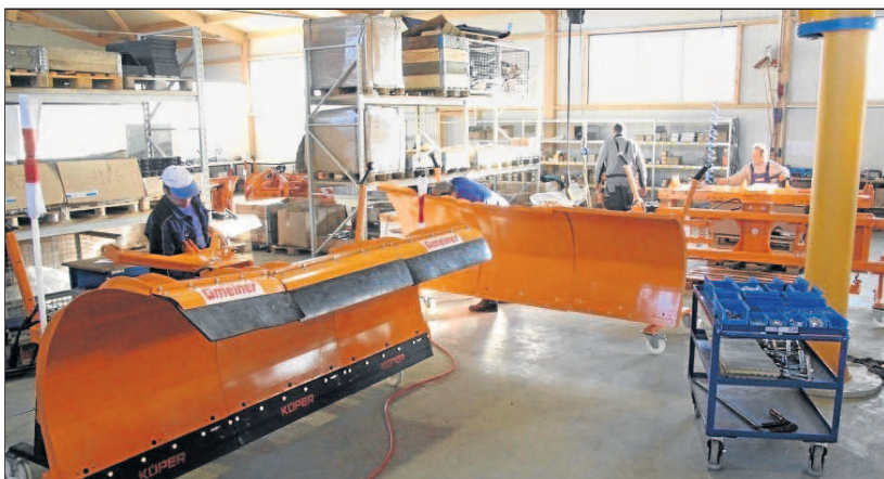
In der neuen Fertigungshalle erfolgen die Pflugmontage und der Bau von Hydraulik-Anlagen. Bilder: rid(2)
